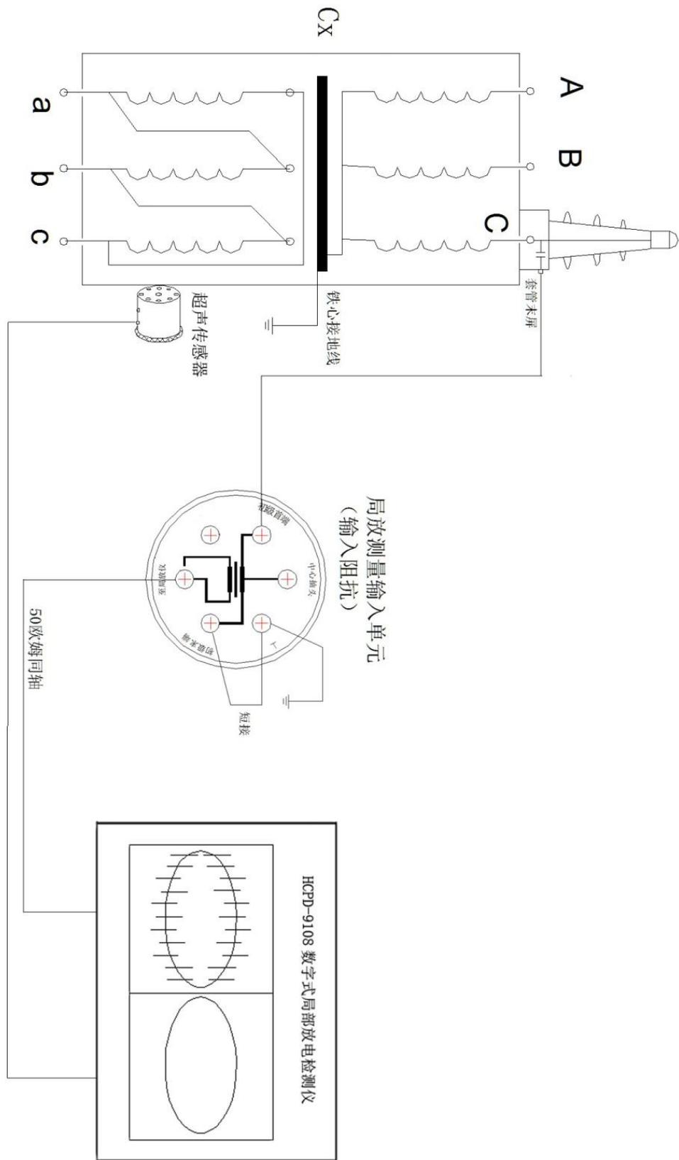
图 3 局放仪试验接线（利用高压套管电容传输放电信号）
