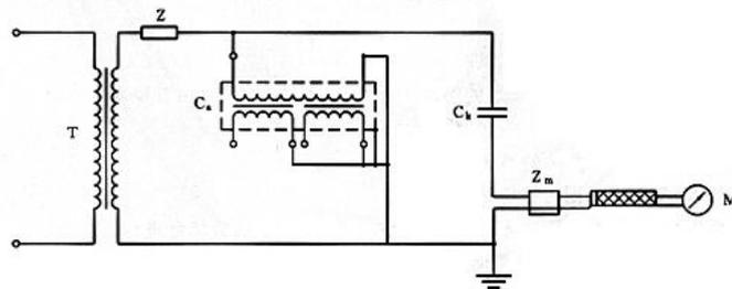
图 6-3-B 输入单元和耦合电容器 Ck 串接
