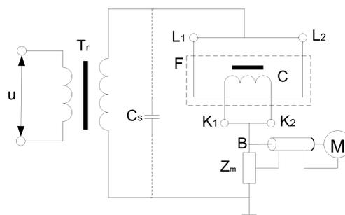
图 6-5-A 电流互感器试验接线
