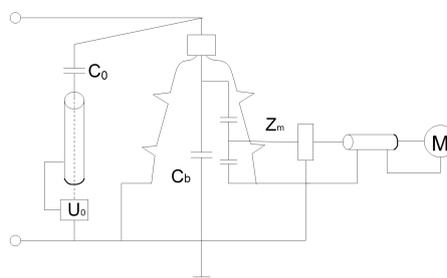
图6-8-C 套管抽头测量和校准接线
