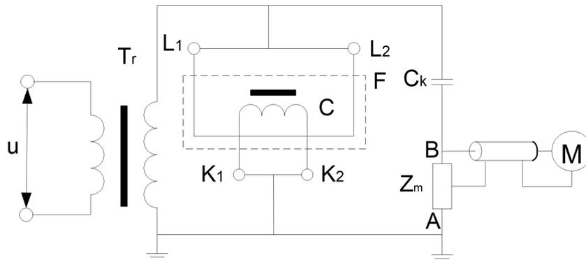
图 6-5-C 接有耦合电容器 Ck 的试验接线
