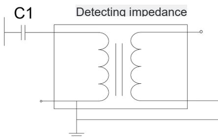
图 4-7 仅测量局放的接线示意图
