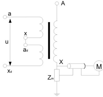
图 6-4-A 无耦合电容器  $C_k$  试验接线
