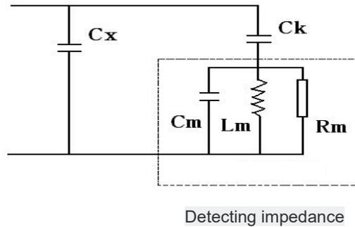
图 4-4 RLC 型输入单元的检测回路及等效电路示意图（并联法）
