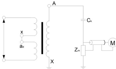
图 6-4-C 接有耦合电容器  $C_k$  的试验接线
