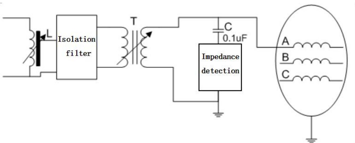
图6-7 发电机的局放测试接线
