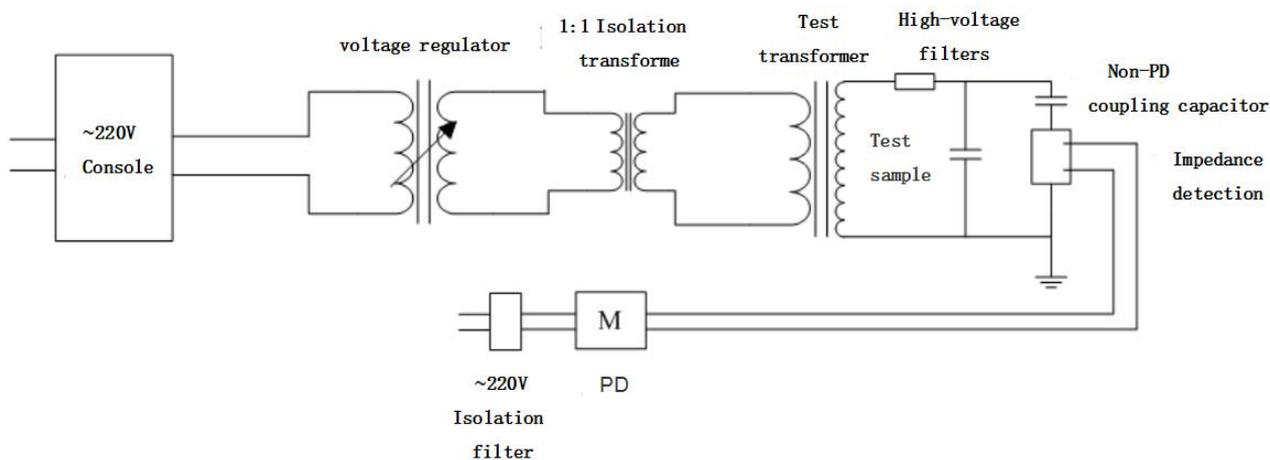
图 6-2 采用并联法系统接线原理图
