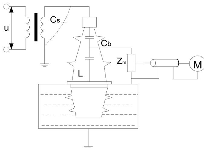
图 6-6 变压器套管接线
