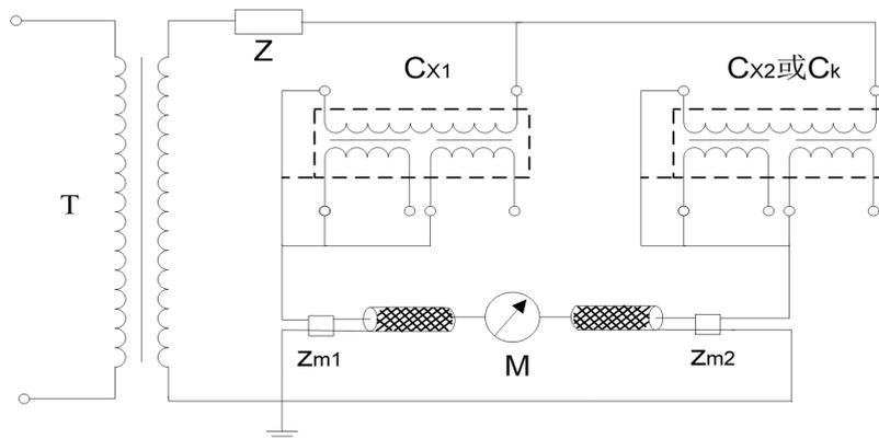
图 6-3-C 平衡回路
