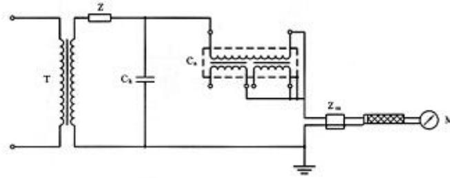
图 6-3-A 输入单元和电压互感器串接
