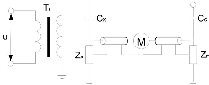
图 6-5-B 抑制干扰的平衡法接线
