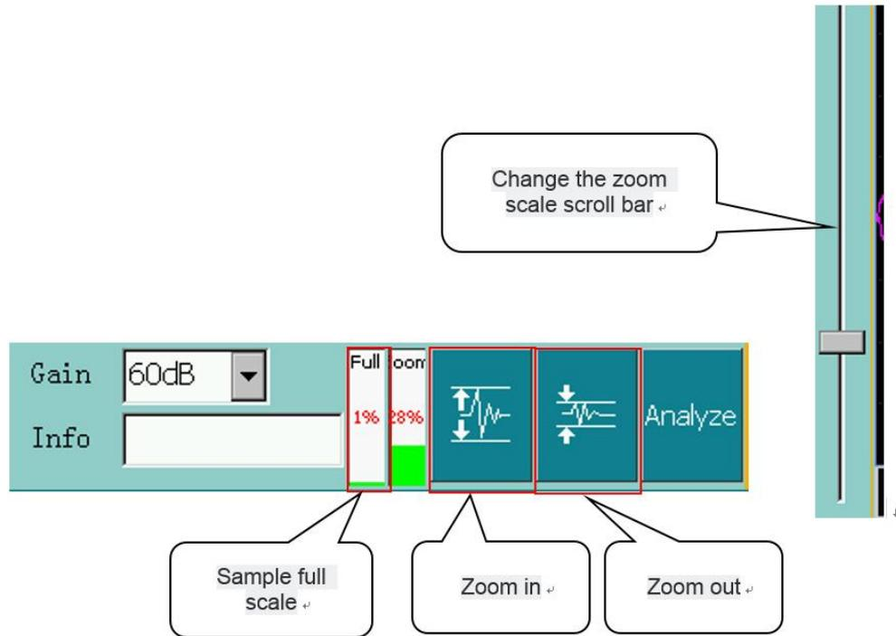
图 5-10 采样满幅和缩放比例
