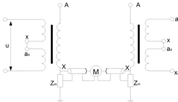
图 6-4-B 抑制干扰的平衡回路接线
