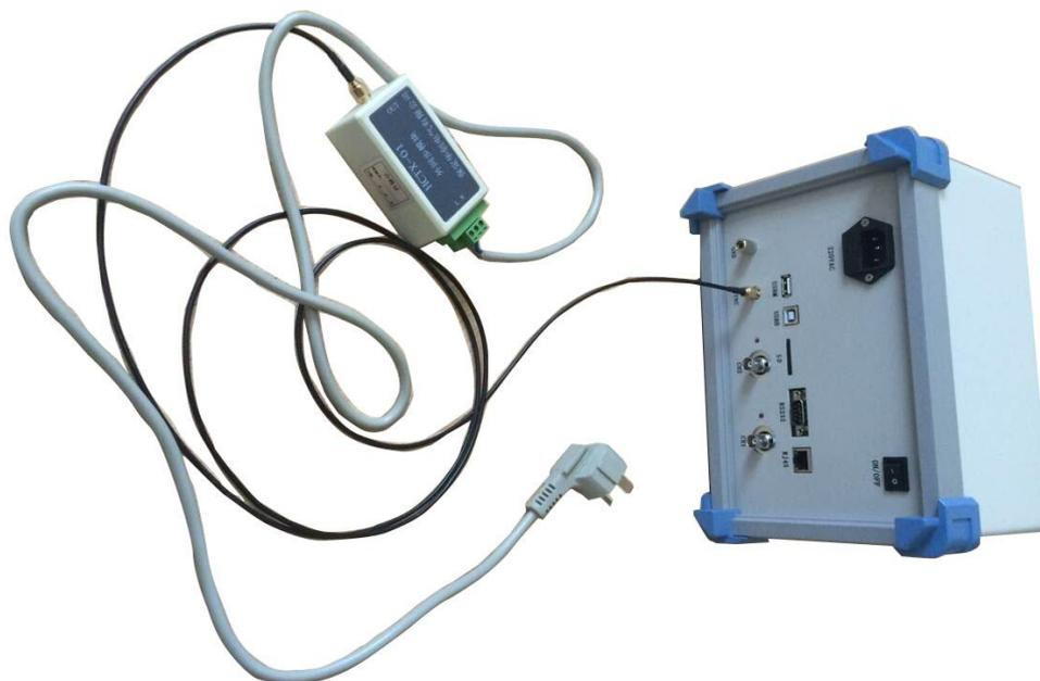
图 5-36 外同步接线图
